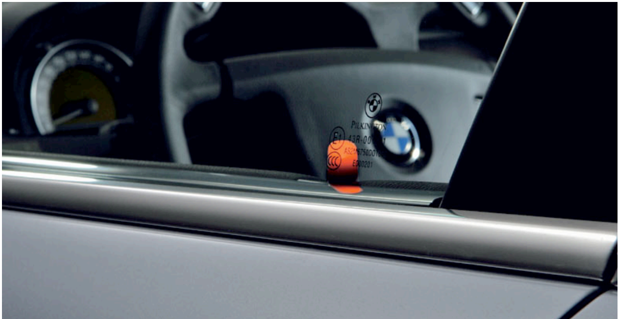
Abbildung 27: Gaswarnanlage des BMW Hydrogen7. Die LEDs der Gaswarnanlage sind in die Türpins integriert und blinken, wenn ein Gasalarm anliegt (Foto: BMW).
