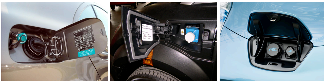
Abbildung 25: Unterschiedliche Tankdeckel, a. bivalentes Benzin-/Erdgasfahrzeug, b. Elektrofahrzeug, Ladestecker im Kotflügel, c. Elektrofahrzeug mit zwei Ladesteckern an der Fahrzeugfront.
