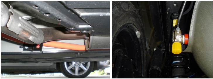
Abbildung 24: Blick unter das Fahrzeug, a. Hochvoltkabel, b. Gastank
