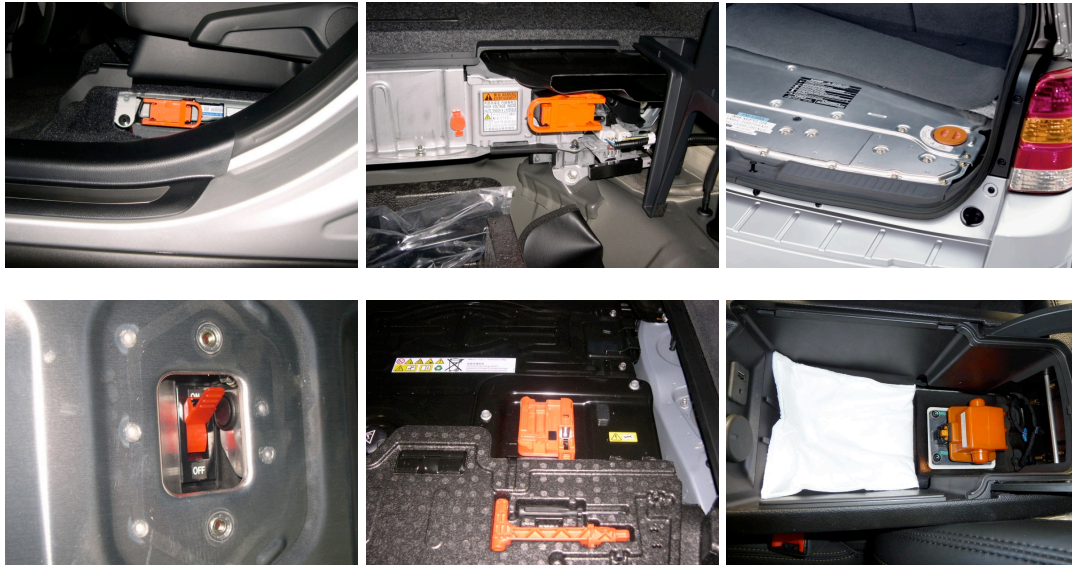
Abbildung 17: Beispiele für Wartungsstecker an unterschiedlichen Fahrzeugen
