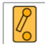
Service/Notfalltrennschalter (zur Deaktivierung des HV Systems)
