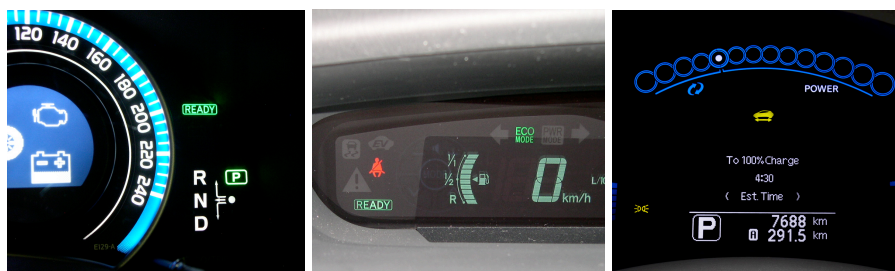
Abbildung 29: Beispiele für "Ready-Indikatoren" bei verschiedenen Hybrid- und Elektrofahrzeugen
