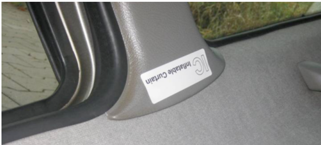
Abbildung 36: Nachträgliche angebrachte Kennzeichnung eines Kopfairbags
