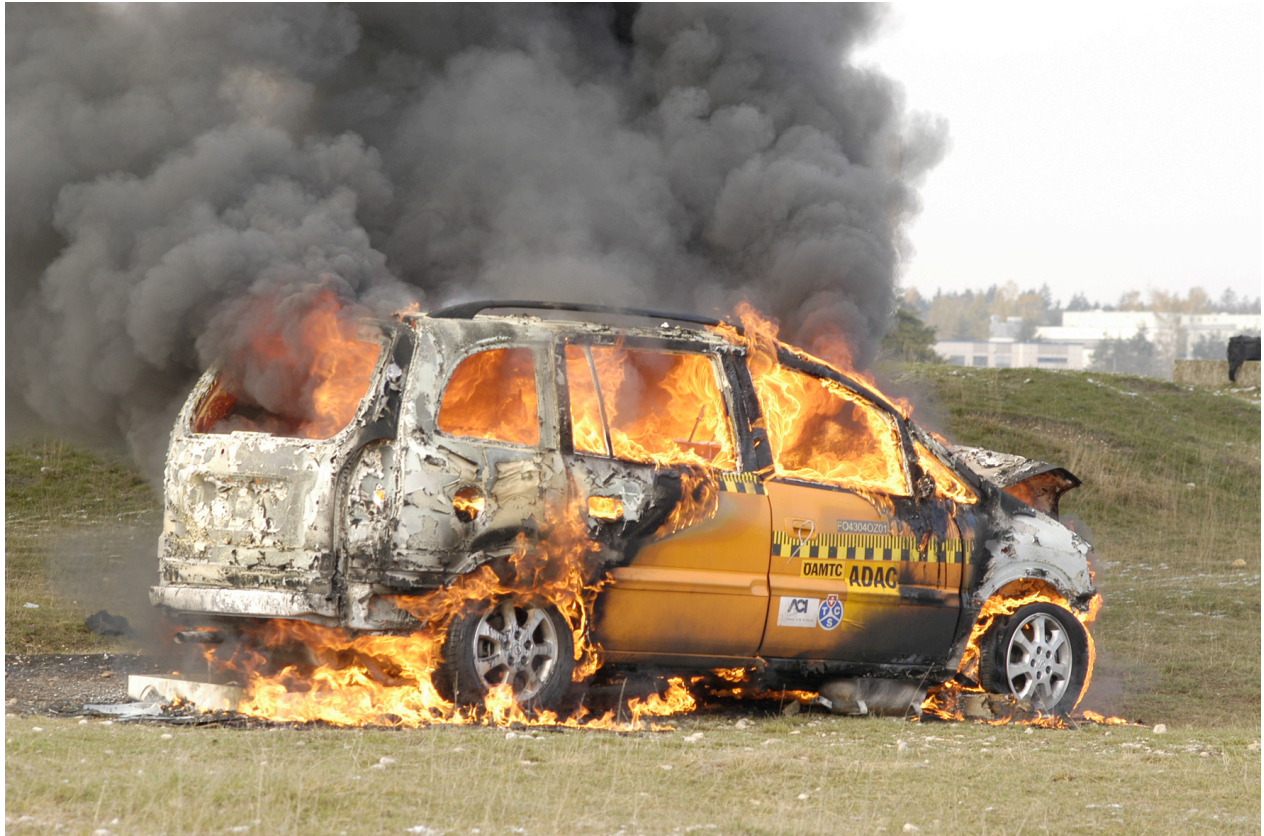
Abbildung 6: Brandversuch an einem Erdgasfahrzeug. Um einen Druckbehälterzerknall zu vermeiden sorgen die Thermosicherungen an den Erdgastanks für ein definiertes Ablasen des Erdgases bei Temperaturbeaufschlagung (Foto: ADAC)
