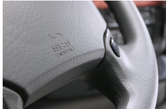
Abbildung 12: Fahrerairbag mit entsprechender Beschriftung bei einem LKW (Foto: Volvo Trucks)
