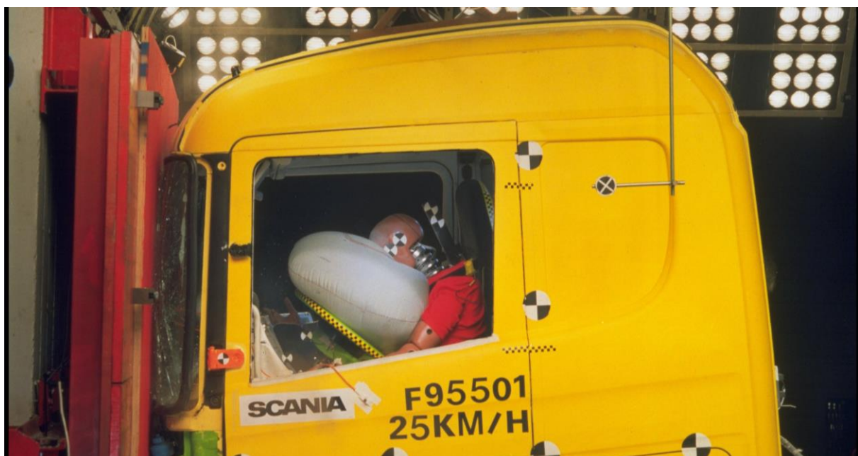
Abbildung 13: Auch in LKW gilt, dass der Sicherheitsgurt der Lebensretter Nr. 1 ist! Die Schutzwirkung des Sicherheitsgurtes kann ggf. durch Gurtstraffer und einen Fahrerairbag ergänzt werden. (Foto: Scania)
