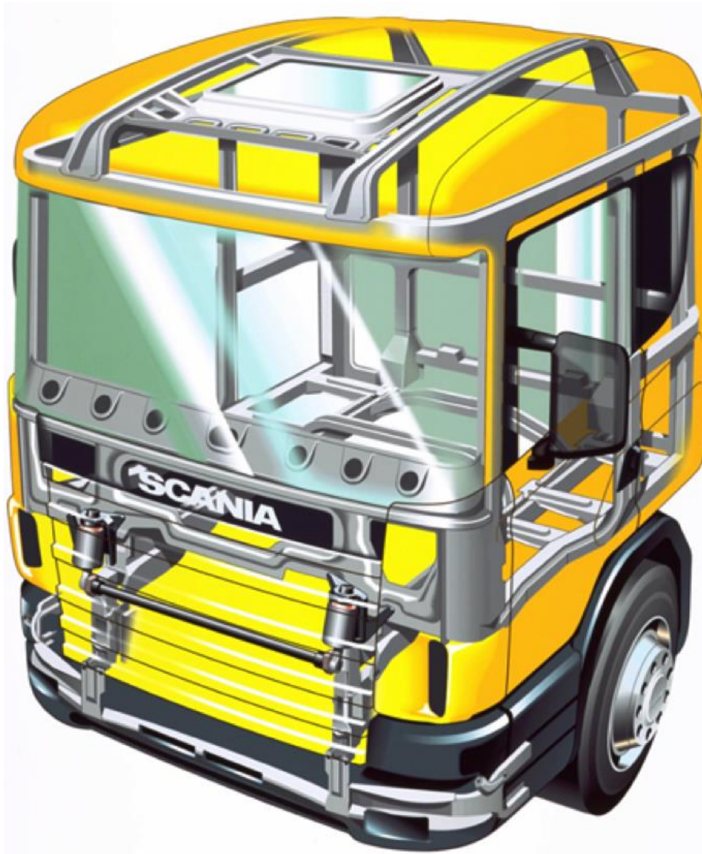
Abbildung 4: Kontruktion eines LKW-Fahrerhauses. (Grafik: Scania)
