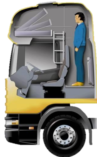
Abbildung 8: LKW verfügen häufig über Ruheliegen für die Insassen. (Grafik: Scania)
