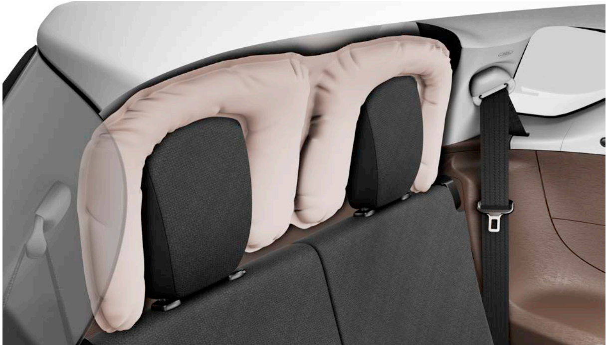
Figuur 19: Gordijnairbag achter bij een Toyota/Scion iQ. (afbeelding: Toyota)
