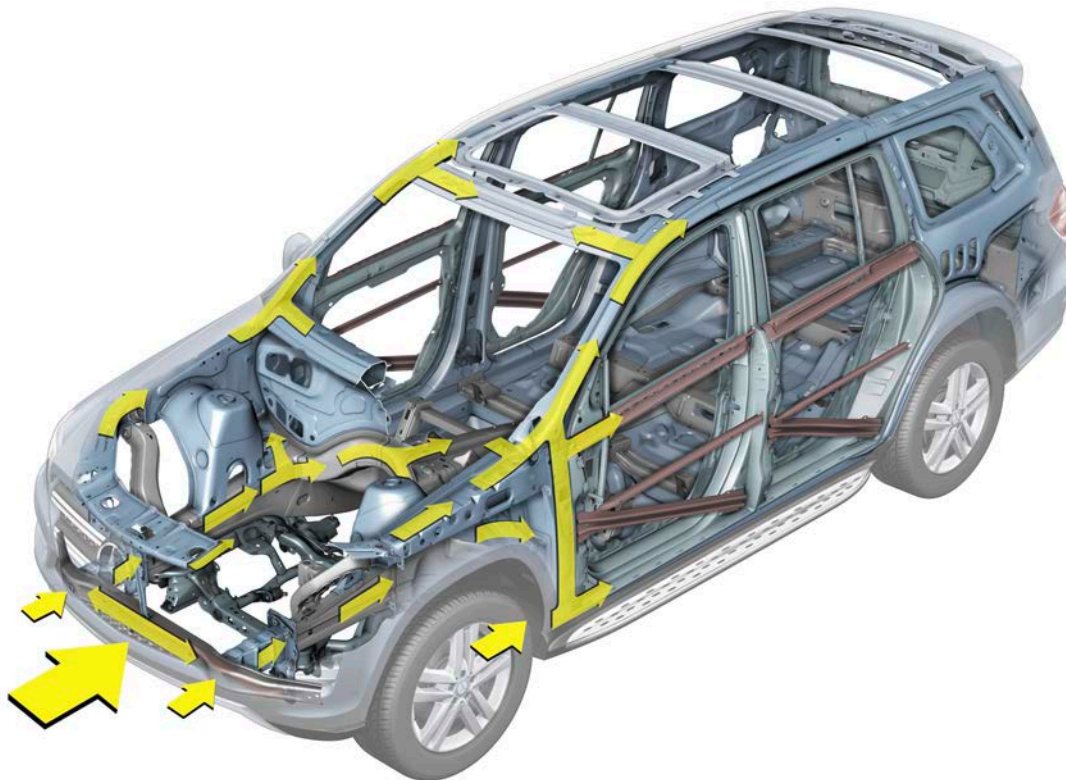
Figuur 3: Carrosserie opbouw van een Mercedes-Benz GL-Class. De pijlen geven de richting van de belasting tijdens een frontale aanrijding weer. De constructie aan de voorzijde is ontworpen als een kreukelzone en absorbeert de energie. De veiligheidskooi moet zo lang mogelijk in tact blijven. (afbeelding: Daimler)
