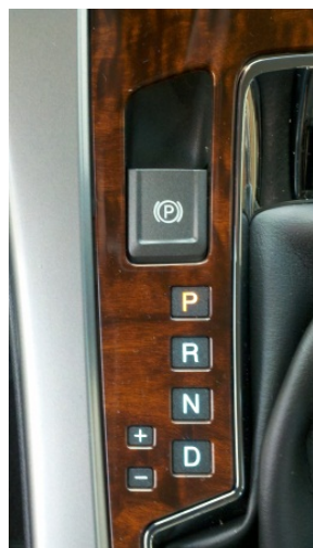
Figuur 2: De elektrische bediening van de parkeerrem in de Buick LaCrosse van 2012.
