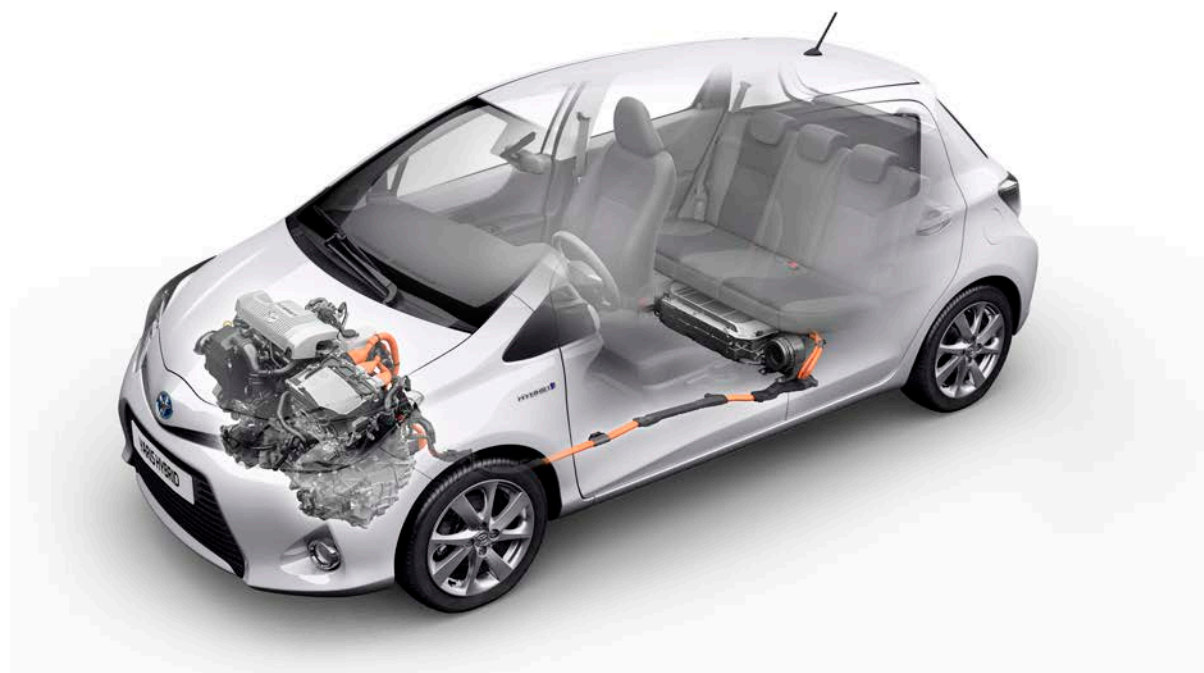
Figuur 46: Deze afbeelding van een Toyota Yaris Hybrid toont duidelijk de inbouwlocatie van de hoogvoltage componenten. De hoogvoltage accu bevindt zich onder de achterbank. Oranje hoogspanningskabels lopen onder de bodemplaat naar de motorruimte, waar zij met de electromotoren en overige hoogvoltage componenten verbonden zijn. (afbeelding: Toyota).
