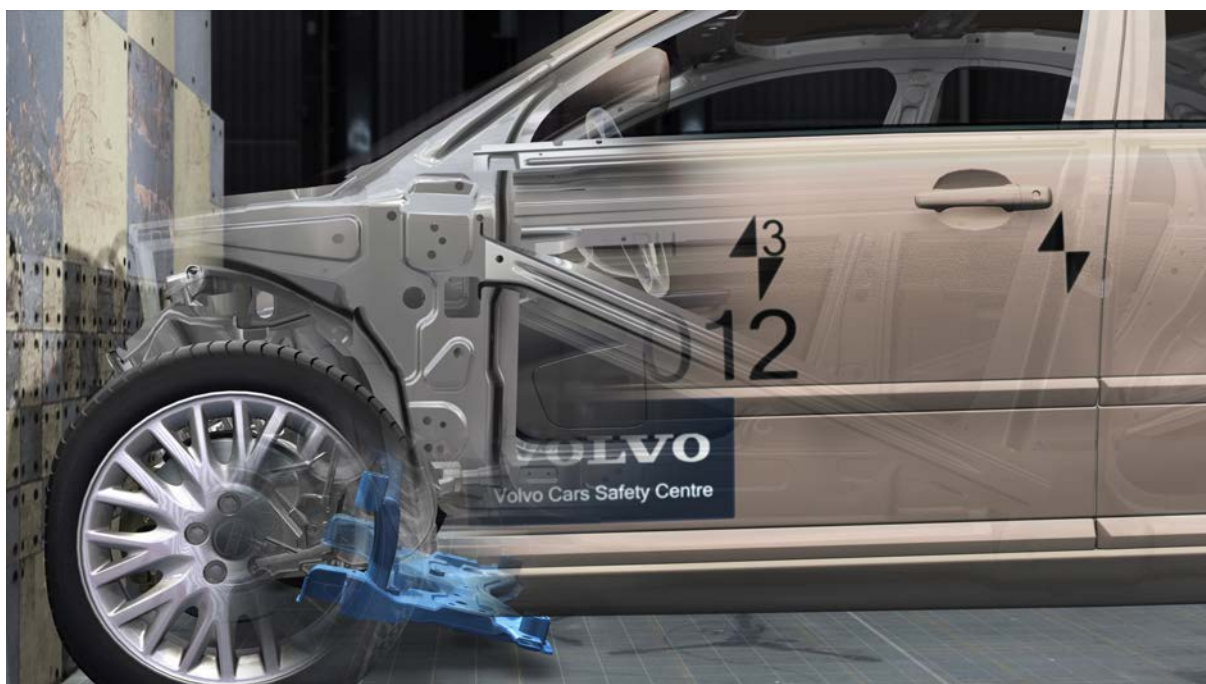
Figuur 5: De wielen worden tegen de A-stijl gedrukt en worden ondersteund zodat de vorm van de bodem ter hoogte van de pedalen in tact blijft. (afbeelding: Volvo)
