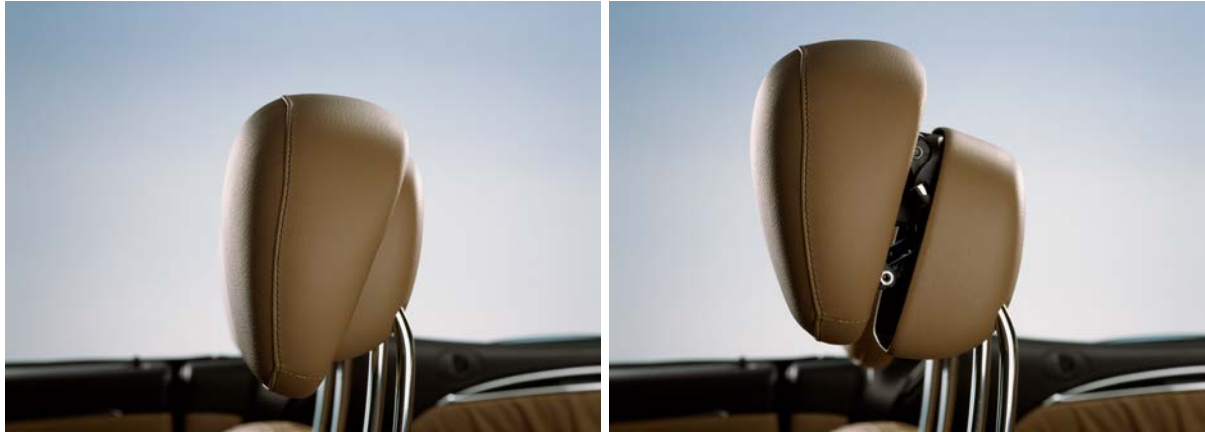
Figuur 17: Het Neck-Pro whiplash protection system van Daimler reduceert de ruimte tussen het hoofd van de inzittende en de hoofdsteun om verrekken van de halswervels te voorkomen. (afbeelding: Daimler)
