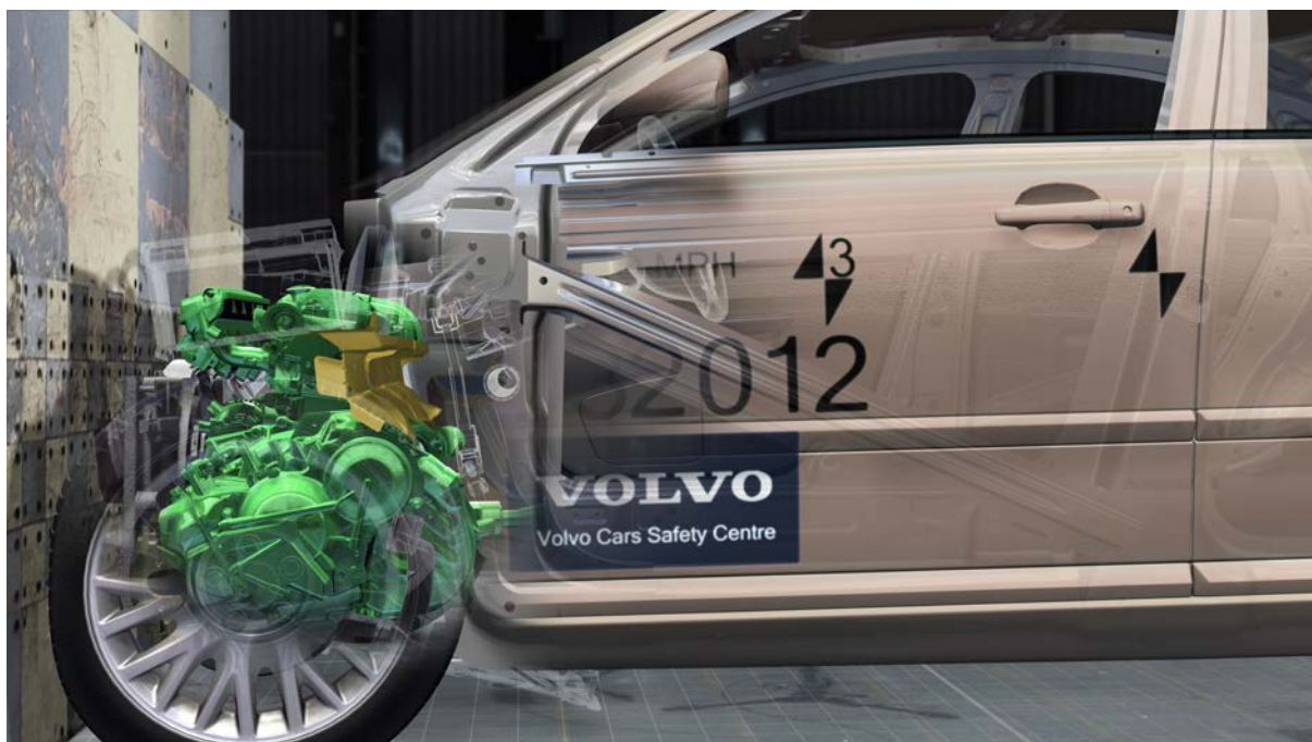
Figuur 4: Een dwarsbalk welke beide A-stijlen verbindt, houdt de motor buiten de veiligheidskooi. (afbeelding: Volvo)
