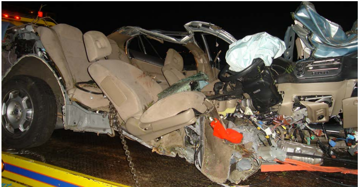
Figuur 48: Zwaar beschadigde Honda Civic Hybrid na een ongeval met een boom. De geactiveerde airbag is een indicatie dat het hoogvoltage systeem automatisch uitgeschakeld is (Uitschakelen). Desondanks dient men er altijd vanuit te gaan dat de hoogvoltagecomponenten onder spanning staan en volledig opgeladen zijn. De hoogspanningskabels zijn duidelijk zichtbaar rechts op de foto en kunnen gemakkelijk herkend worden aan de oranje kleur. Het is niet nodig de hoogspanningskabels door te knippen. De hoogvoltage accu bevindt zich achter de leuning van de achterbank. Deze is niet beschadigd gedurende het ongeval, wat een bevestiging is dat dit soort componenten op de veiligste locaties in het voertuig zijn ingebouwd (Veilig verpakken).
