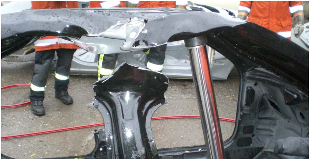
Figuur 32: De B-stijl van deze Mercedes-Benz S-Klasse is met een hydraulische cylinder afgescheurd. De cylinder werd tussen de dorpel en dakrand geplaatst en vervolgens uitbewogen. Het dak kon zo compleet van de B-stijl afgescheurd worden.
