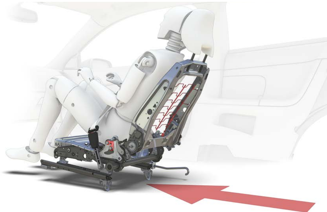
Figuur 18: Stoelen van moderne Volvo's zijn uitgerust met het WHIPS (Whiplash Protection System). Bij dit systeem beweegt de complete stoelleuning samen met de inzittende tijdens een achteraanrijding. Hiervoor is de stoel uitgevoerd met een metalen gedeelte wat tijdens het ongeval verbuigt en zo energie absorbeert. (afbeelding: Volvo).
