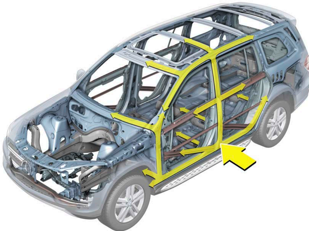
Figuur 12: Carrosserie opbouw van een Mercedes-Benz GL-Class. De pijlen geven de richting van de belasting tijdens een zij-aanrijding weer. In tegenstelling tot frontale aanrijdingen is de afstand tussen de inzittenden en zijconstructie beperkt. Daarom is er geen echte kreukelzone om energie op te nemen. De fabrikant probeert de zijconstructie te verstevigen om indringing in het compartiment te minimaliseren. (afbeelding: Daimler)
