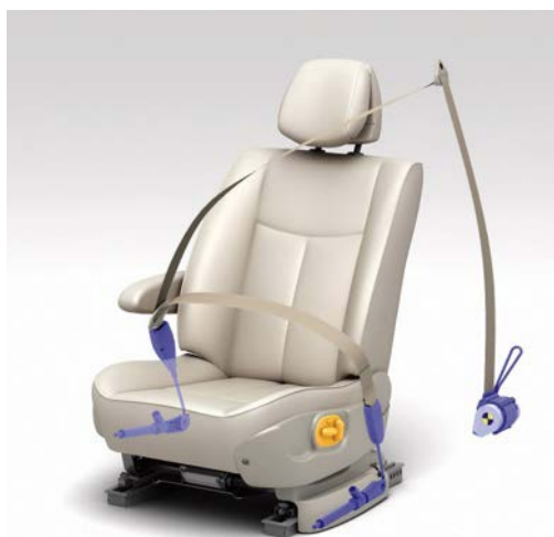
Figuur 42: Bestuurdersstoel met gordel. De gordelspanner kan op het rolmechanisme gemonteerd zijn, de sluiting, of op de bevestiging van de heupgordel. In dit geval is een gordelspanner gemonteerd op de heupgordelbevestiging en de gordelsluiting. (afbeelding: Renault)
