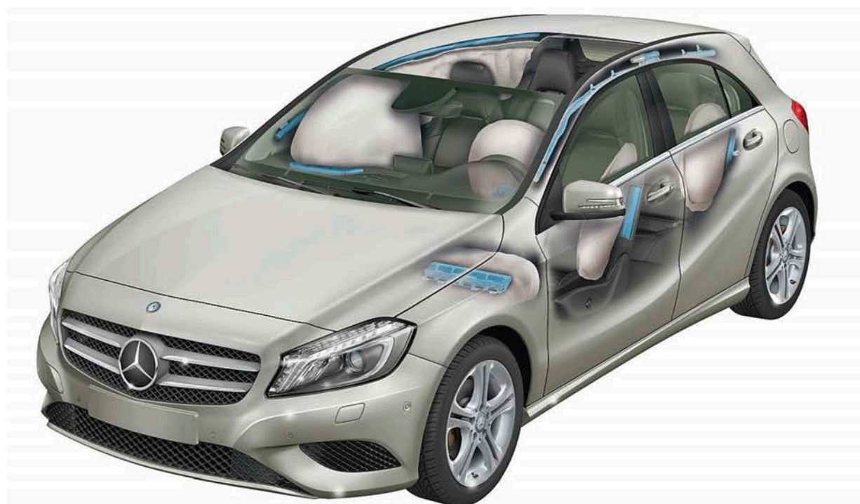
Figuur 41: Airbag componenten van de Mercedes-Benz A-Klasse. Een bestuurdersairbag, een bestuurders knie-airbag, een passagiers airbag en in de voor- en achterstoelen gemonteerde zij-airbags zijn zichtbaar naast de gordijnairbags in de dakrand. (afbeelding: Daimler)
