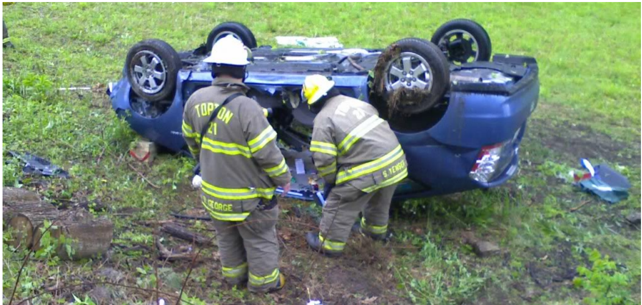
Figuur 50: Deze Toyota Prius is over de kop geslagen. Er zijn geen airbags geactiveerd. Hulpverleners dienen de voertuigen in dit soort situaties handmatig te deactiveren. Het is in dit soort gevallen zeer belangrijk het contact uit te zetten en het 12/24 Volt circuit te onderbreken. In dit geval bevindt de 12/24 Volt accu zich in de kofferruimte en is daarom goed toegankelijk. (afbeelding: Tipton Volunteer Fire Company)
