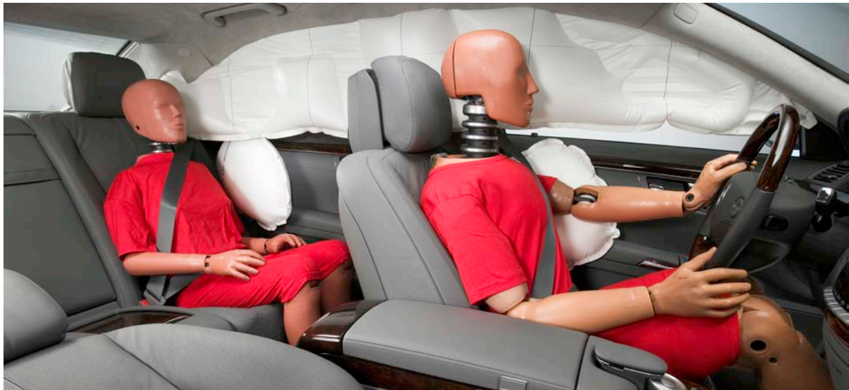
Figuur 13: Deze foto toont zij-airbags gemonteerd in de voor- en achterstoelen, naast de doorlopende gordijnairbag. (afbeelding: Daimler)
