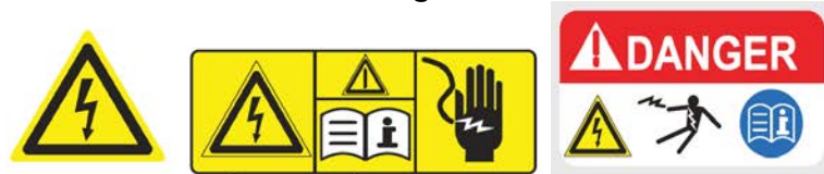
Figuur 47: Voorbeelden van waarschuwingslabels voor hoogvoltage componenten
