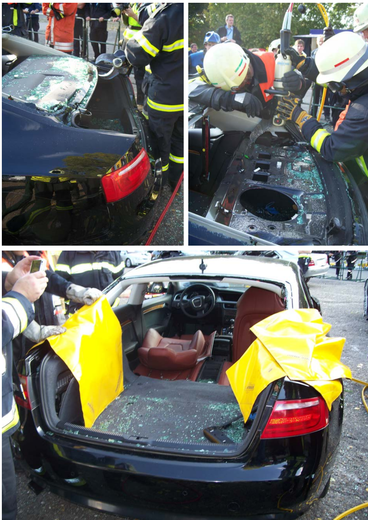
Figuur 39: Tunnel door de kofferruimte van een Audi S5. De kofferdeksel is met een knipschaar verwijderd en de hoedenplank ertussenuit geknipt met een reciprozaag en een knipschaar. Vervolgens is de achterbank uit het voertuig verwijderd.
